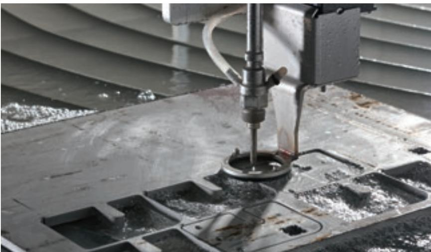
Le système palpeur règle automatiquement la distance optimale entre la tête de coupe et les surfaces de la pièce usinée, en améliorant la qualité de la coupe et en garantissant la sécurité durant les usinages.
