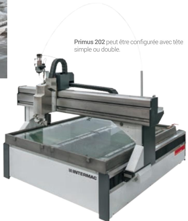
**Le processus de coupe de la technologie Waterjet consiste à usiner les matériaux à l'aide d'un jet d'eau pouvant être additionné de poudre abrasive en utilisant des pressions qui arrivent jusqu'à 400 Mpa.**
