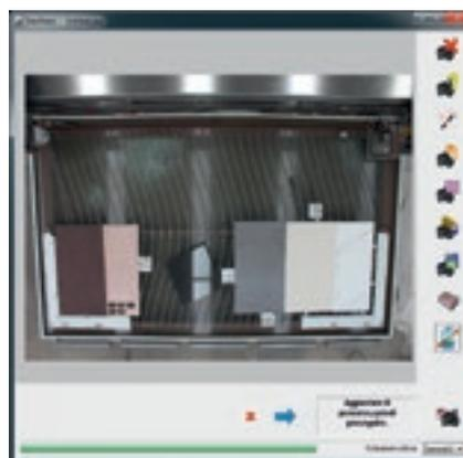
Le système en option de détection photographique est particulièrement indiqué pour les façonnages avec la machine ouverte, où il est important de suivre la morphologie de la pierre naturelle. Un autre avantage concerne la possibilité d'optimiser également les volumes déjà partiellement utilisés, ou encore d'optimiser les volumes en rejetant les éventuelles zones du matériau où se trouve des défauts.
