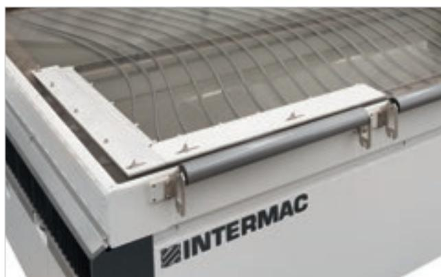
Possibilité de monter des rouleaux avant et arrière pour faciliter le chargement et le déchargement des matériaux.
