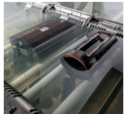
Systèmes de blocage/outillage pour tubes à base ronde ou carrée.
